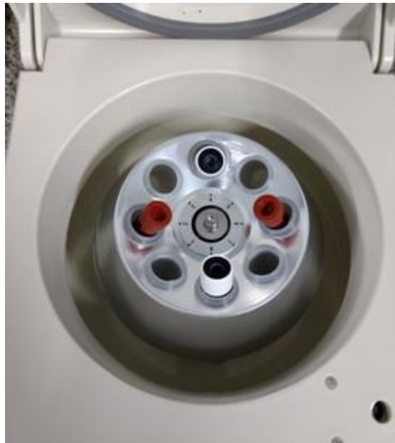
Figura 5: Tubos com o sangue coletado colocados na centrífuga. Os tubos devem ser colocados sempre de forma balanceada, um de frente para o outro e sempre tubos com a mesma composição relacionando-se. 6
