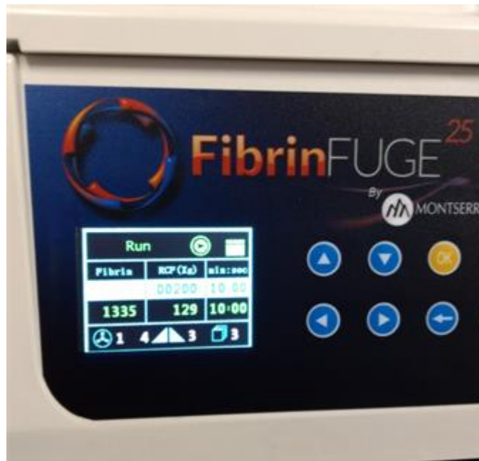
Figura 6: Programação da velocidade de centrifugação, tempo e rpm (a centrífuga FibrinFUGE® já possui os processos pré-programados). 7
