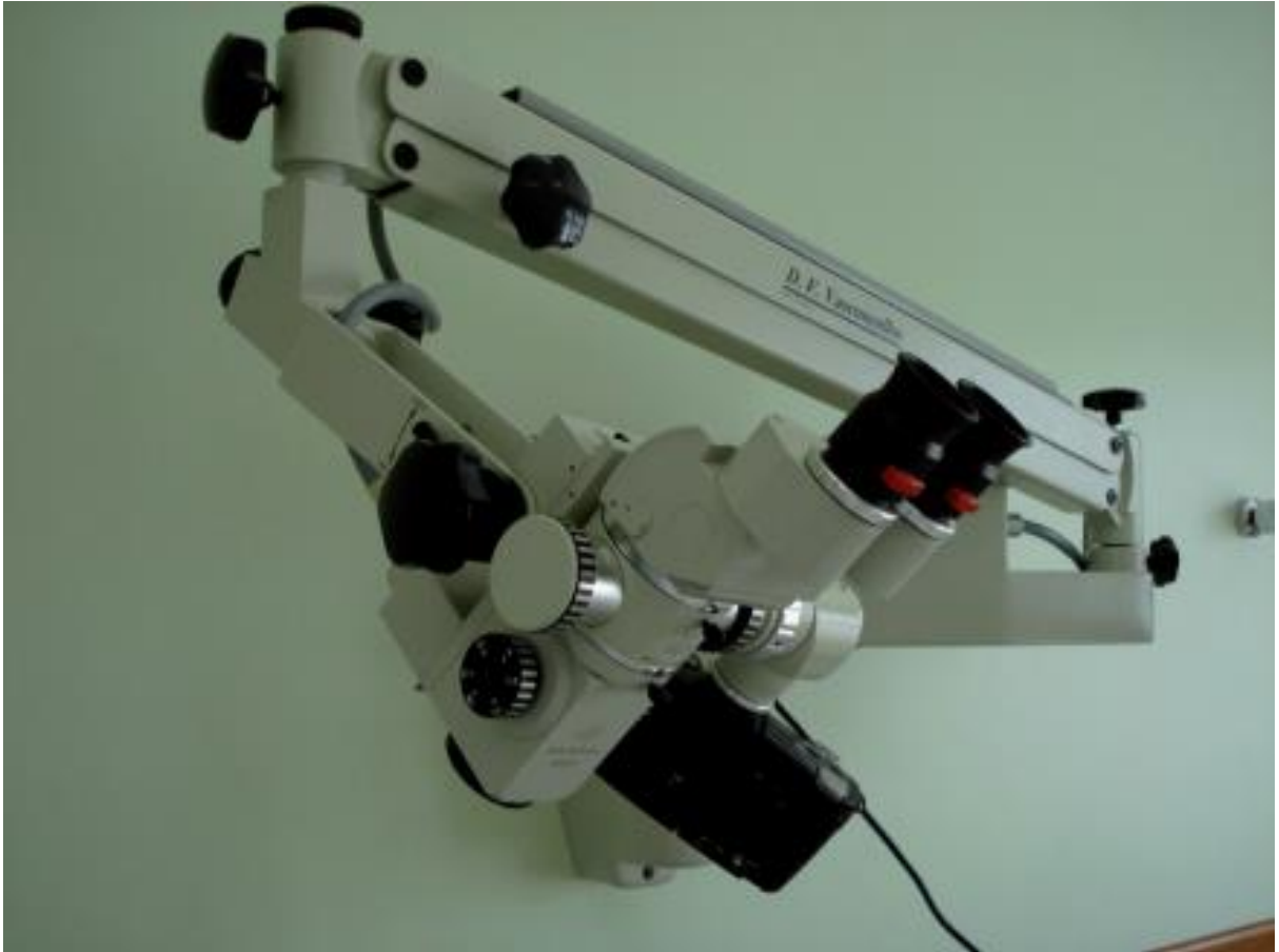
Figura 4 – Microscópio óptico DF Vasconcellos com câmera digital acoplada ao divisor de luz.
