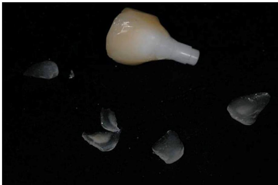
FIGURA 2: Lascagem múltipla da cerâmica de revestimento em um baseado em zircônia implante coroa única. *Sailer I, Karasan D, Todorovic A, Ligoutsikou M, Pjetursson B, Prosthetic failures in dental implant therapy, Periodontology 2000, 2022;88:130–144, DOI: 10.1111/prd.12416*
