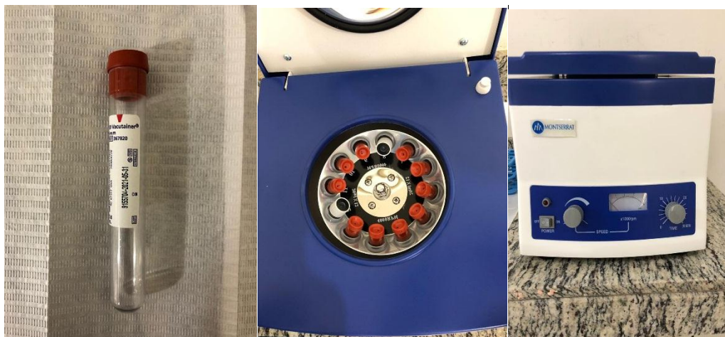
Figura 1: Tubo BD Vacutaine Serum/Levados a centrífuga de bancada/Centrífuga Analógica MontSerrat
