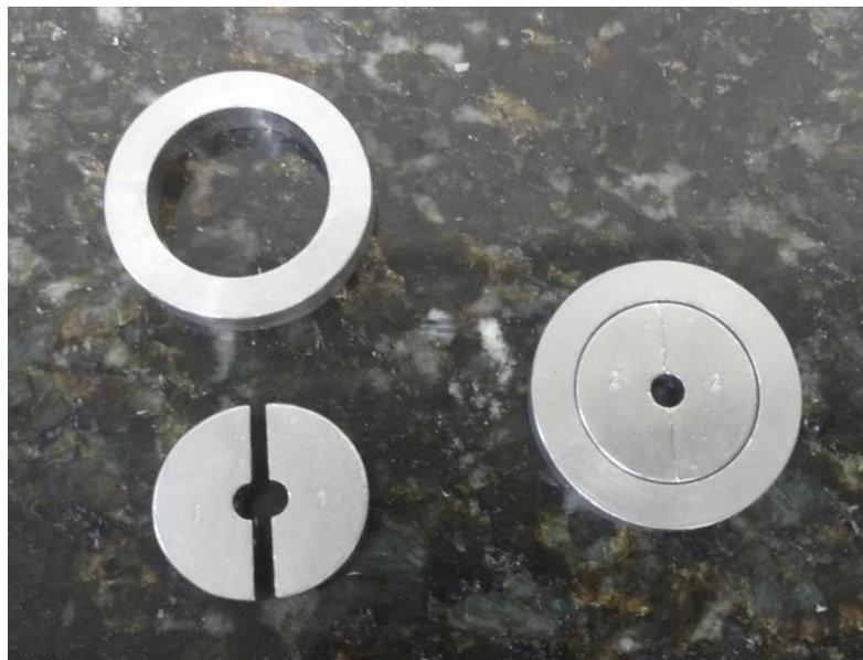
Fig. 6. Matriz dos corpos de prova para o ensaio de compressão, seus componentes e montada para confecção dos blocos. Fonte: acervo próprio.
