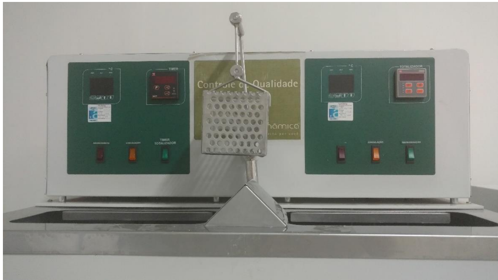
Fig. 10. Máquina de termociclagem. O tanque da esquerda contém a água fria, o da direita contém a água quente. A cesta central oscila entre eles conforme intervalo determinado. Fonte: acervo próprio.
