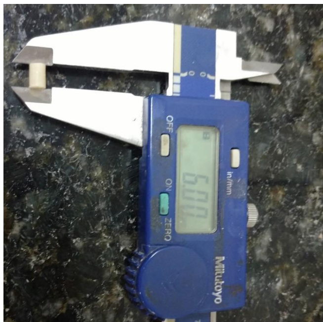
Fig. 7. Confirmação das medidas exatas dos corpos de prova com paquímetro digital. Fonte: acervo próprio.
