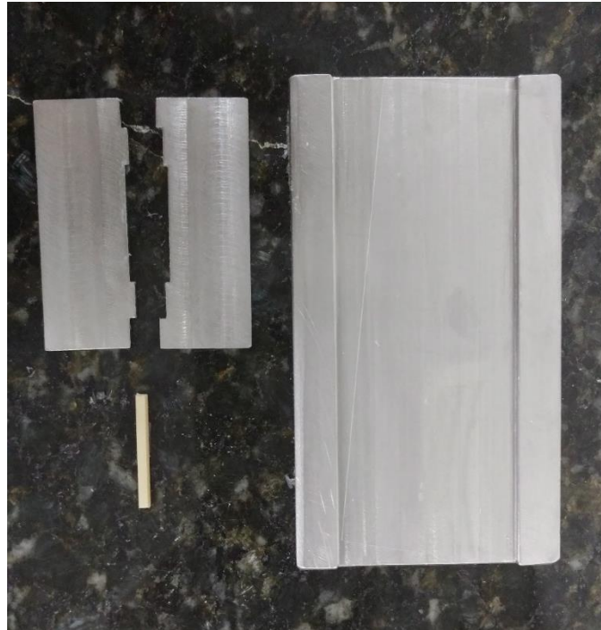
Fig. 3. Matriz de confecção de corpos de prova para o teste de flexão. Fonte: acervo próprio.
