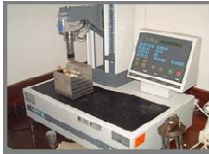
Figura 13 – As amostras montadas no bloco sob o tensômetro
