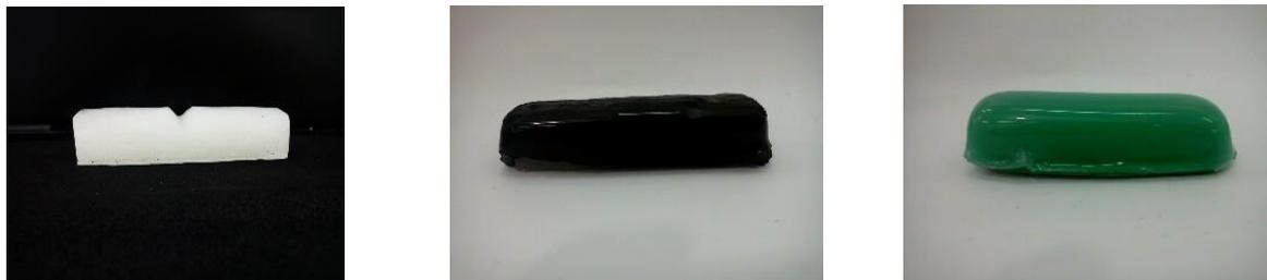
Figuras 36, 37 e 38 Respectivamente: Corpo de prova sem revestimento / Corpo de prova revestido com placa de EVA de 3mm / Corpo de prova revestido com placa de EVA de 5 mm.
