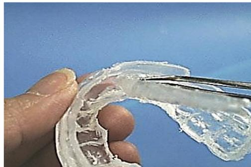
Figura 17 - A remoção do tubo é facilmente conseguida porque os materiais de folha e de tubo não ficam unidos sem tratamentos de superfície.
