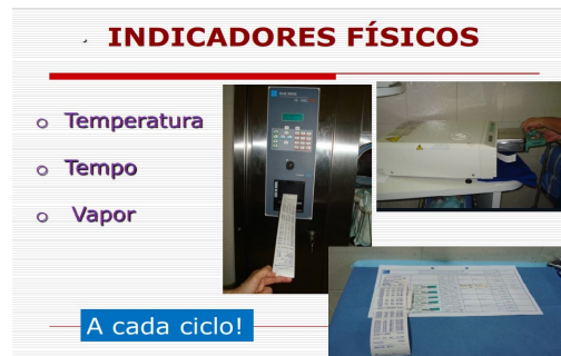
Fig. 6 – Indicadores físicos em fitas específicas para esterilização 6
