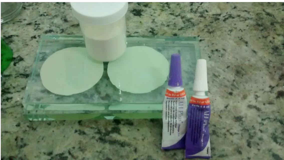
Figura4: Cimento B (AH Plus) 48h após a manipulação.
