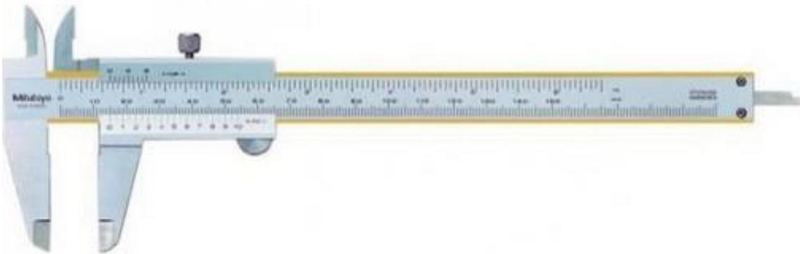
Figura 11: Paquímetro
