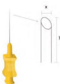
**Figura 6** – Relação entre calibre (X) e comprimento (Y) da cânula
