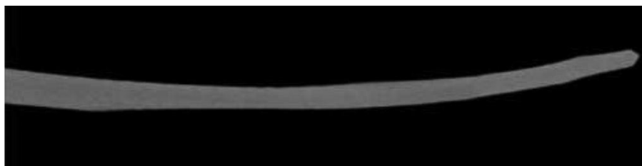
Fig. 5 – Lima escaneada após o uso com deformação visível
