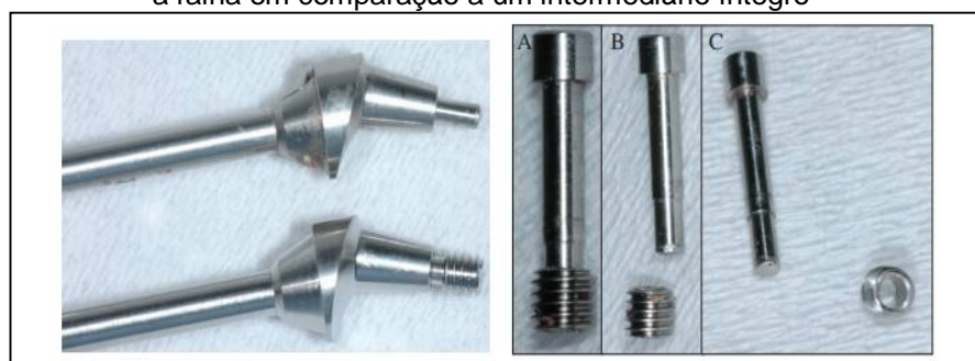
Figura 5 - Minipilar cônico angulado onde observa-se o intermediário após a falha em comparação a um intermediário íntegro
