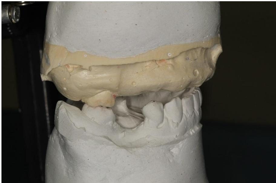
FIGURA 2: MONTAGEM DOS MODELOS EM ARTICULADOR SEMI-AJUSTÁVEL
