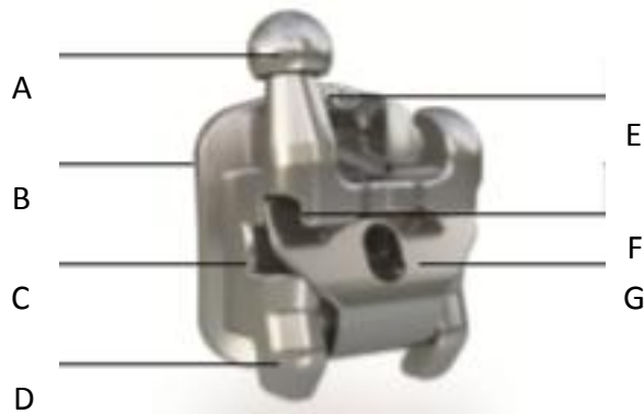
Figura 34: Perfil baixo e ganchos arredondados (A), Contornos da base de Máxima Retenção™ (B), Entradas de slots chanfradas (C), Aletas estendidas (D), Linha central (E), Ranhura/trava (F), Clipe de cromo-cobalto (G)
