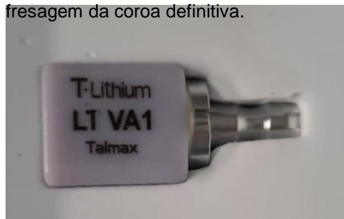
Figura 17 – Bloco escolhido para fresagem da coroa definitiva.
