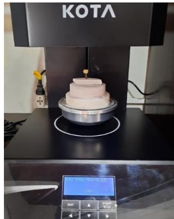
Figura 19 – Peça protética no forno após maquiagem e glaze.
