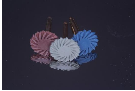
Figura 9: Polimento da peça com borrachas espirais polidoras, evidenciando as granulações: grossa, média e fina.
