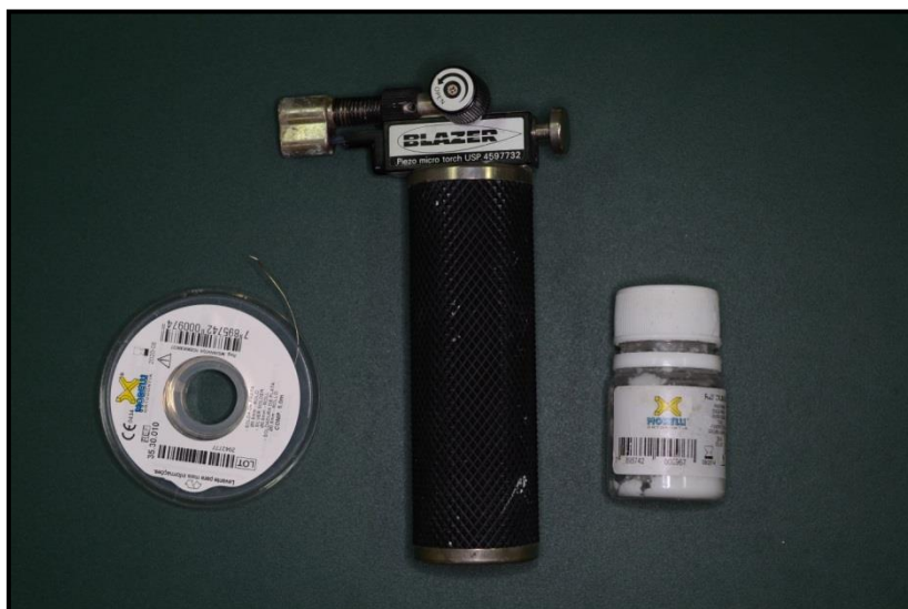
Fig. 5. Material utilizado para solda: solda de prata, pasta para solda de prata e maçarico.
