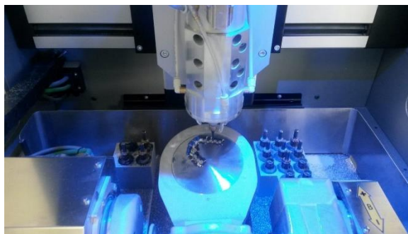
Figura 9 – Usinagem do bloco de titânio foto Laboratório Laben Curitiba/Pr
