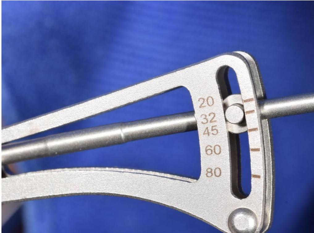
Figura 10 - Torquímetro destacando 32N de torque.
