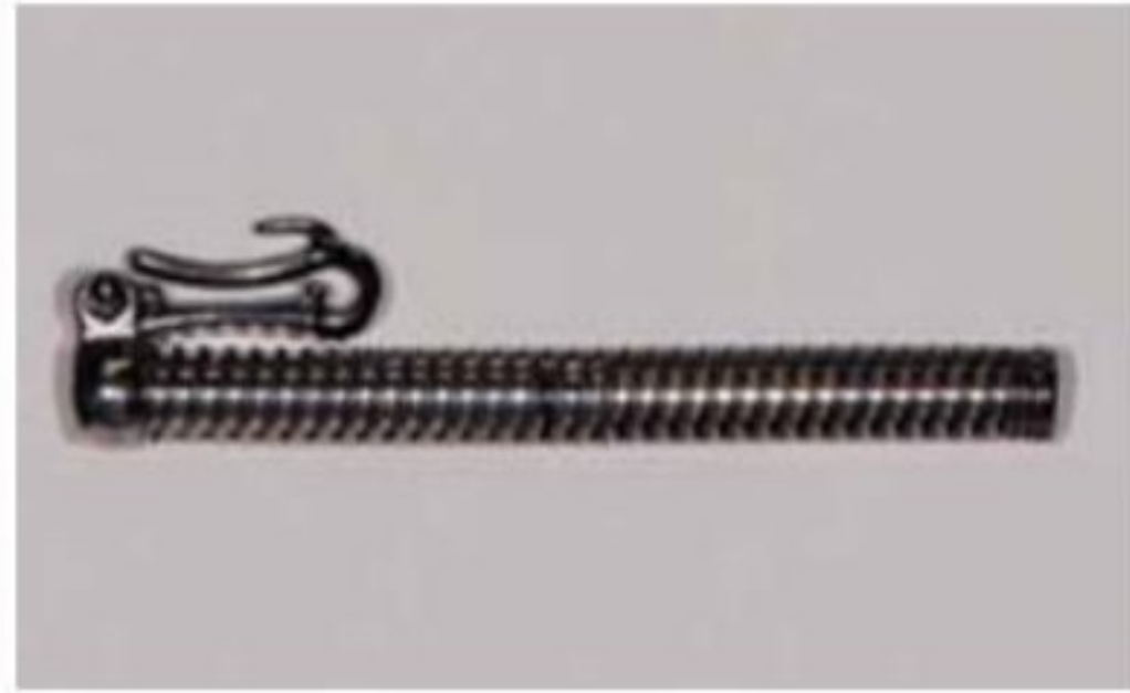
Figura 1 - Mola resistente a fadiga. Constituída de aço inoxidável. A mola não varia o tamanho, o que muda é o tamanho do pistão.
