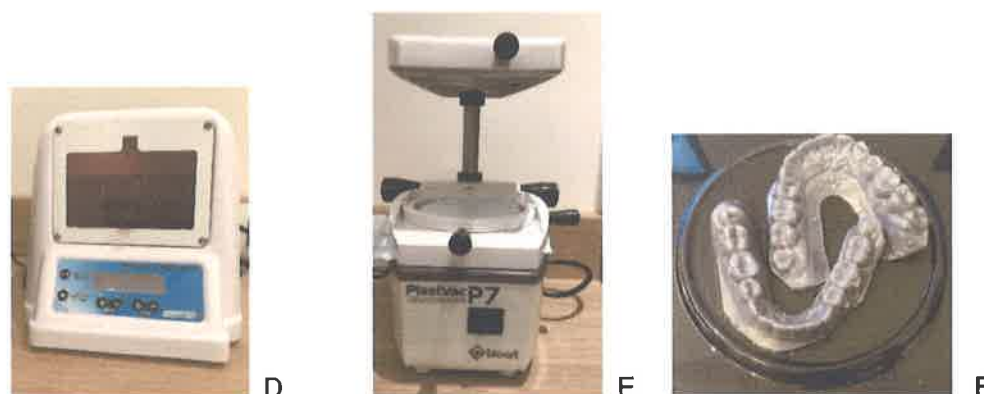
Figura 4.3 A-E– Modelo físico (A), Impressora W3D - Wilcos (B e C), Curadora Photon Flash Maxx – Essense Dental (D), Plastificadora PlasVac P7- Bioart (E) e Alinhadores, resultado das placas prensadas à vácuo nos modelos em resina (F).
