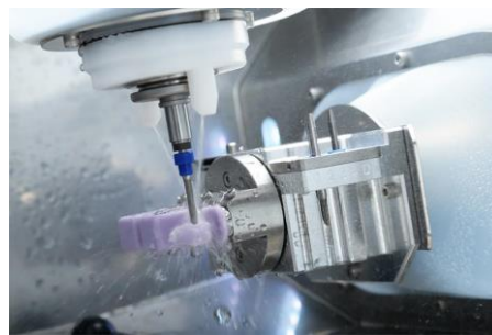
Figura 5- Processamento CAD/CAM - fonte: Roland DG Brasil
