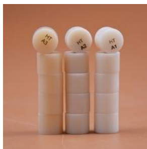
Figura 4. Pastilhas de cerâmica reforçada por dissilicato de lítio - Fonte: Ivoclar vivadent.
