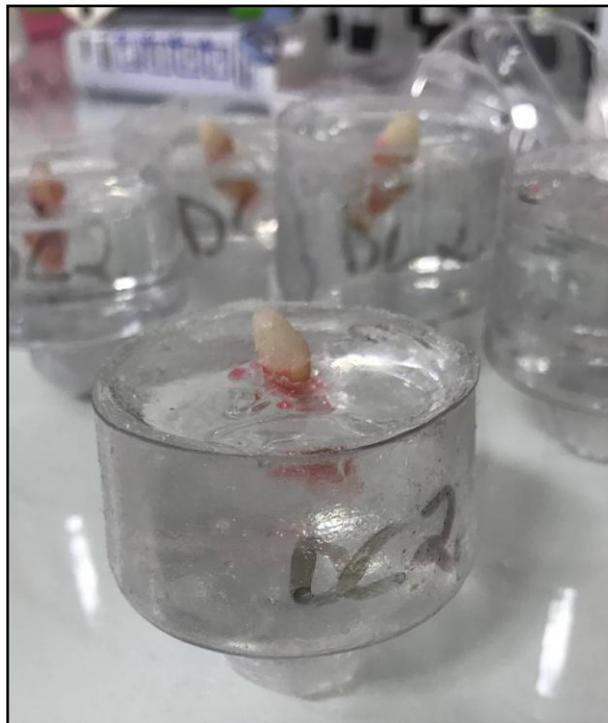
Figura 11. Dispositivos de acrílico prontos para a ciclagem.
