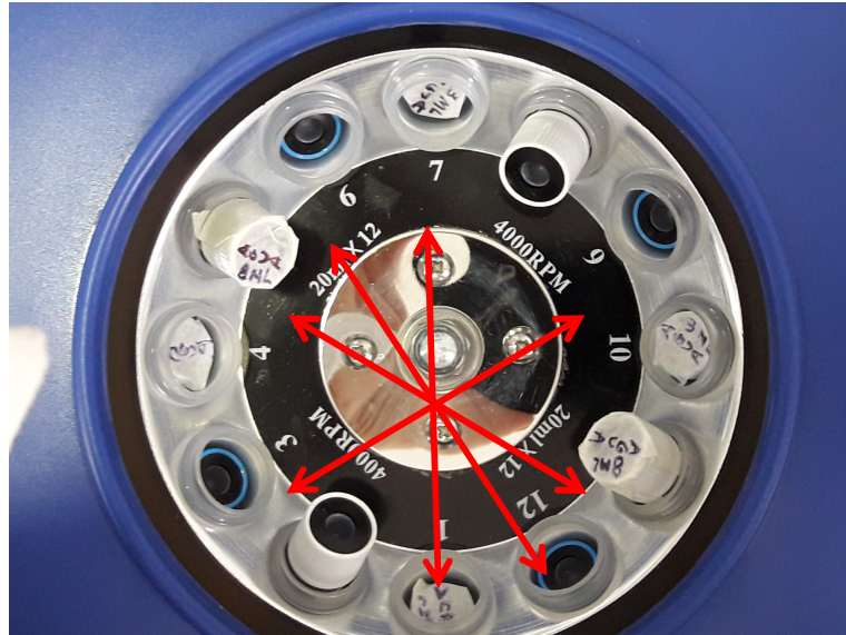
Figura n10. Colocação dos tubos vacunteener na centrífuga de modo a equilibrá-los.
