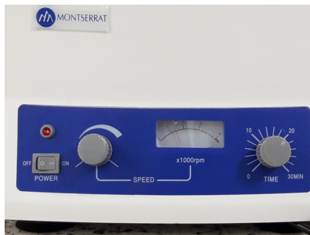
Figura n.11 Centrífuga Montserrat em funcionamento. Colocar os tubos para centrifugar a 1400rpm por 8 min. numa única centrifugação, segundo o protocolo prescrito no curso de pós-graduação de harmonização orofacial UBALDO M.A. (2018).
