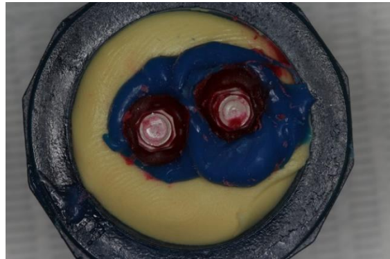
Figura 19: Vazamento com resina acrílica
